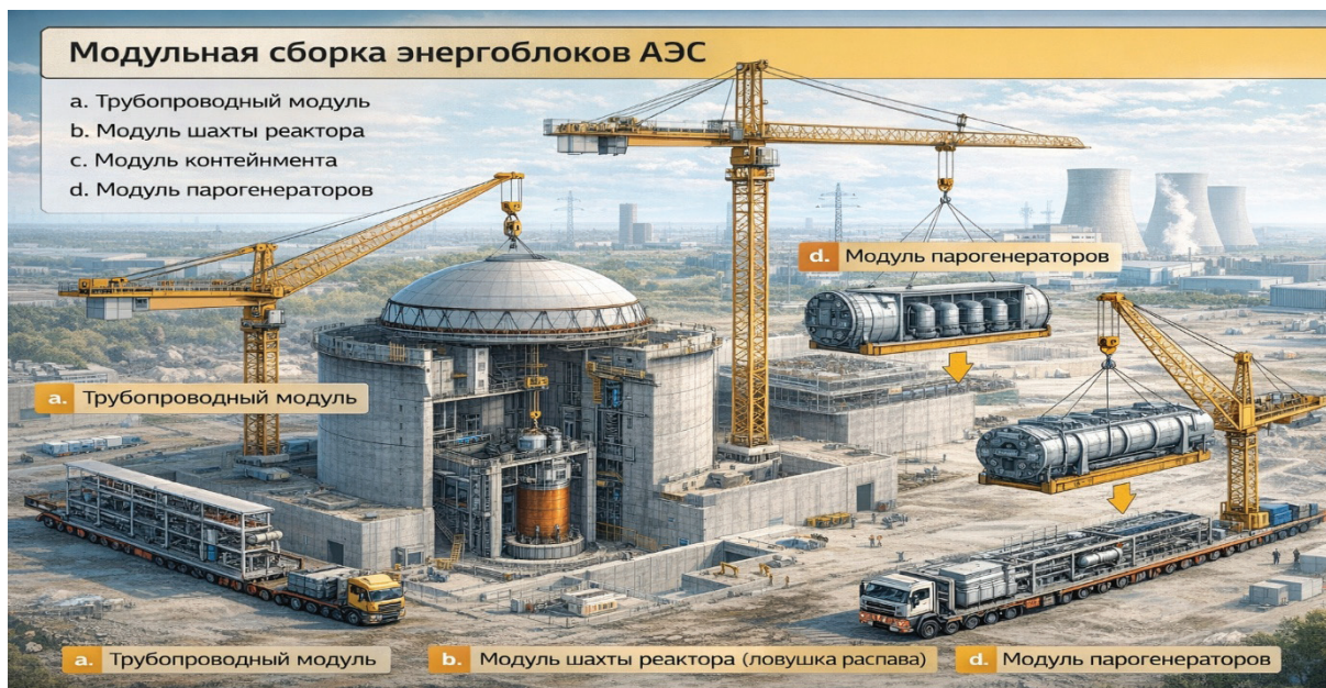
Рис. 1. Принципиальная схема модульной сборки энергоблока АЭС
