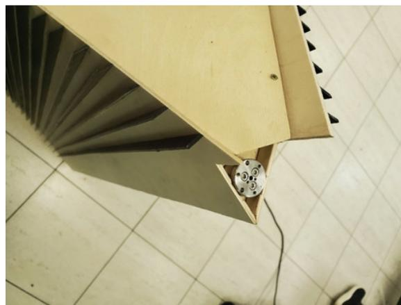
Рис. 11. Узел крепления шестикомпонентного силомоментного датчика
