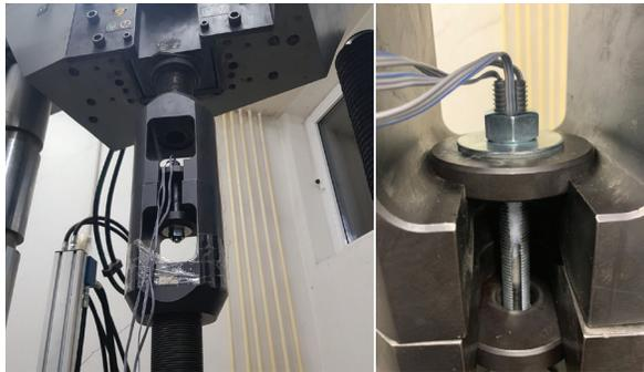
Рис. 5. Испытание шпильки с прорезями
