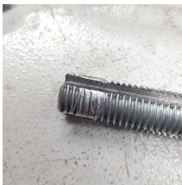
Рис. 10. Шпилька после испытания и разрушения гайки
