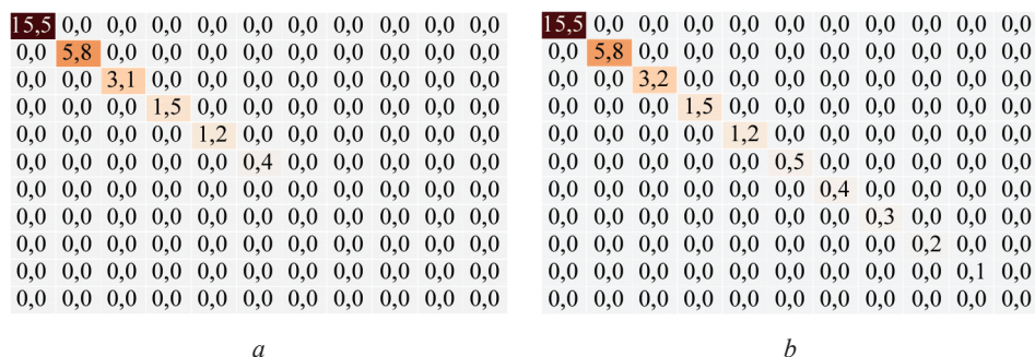
Рис. 10. Матрица \Sigma сингулярных значений: a — незашумленной матрицы перемещений; b — зашумленной матрицы перемещений
