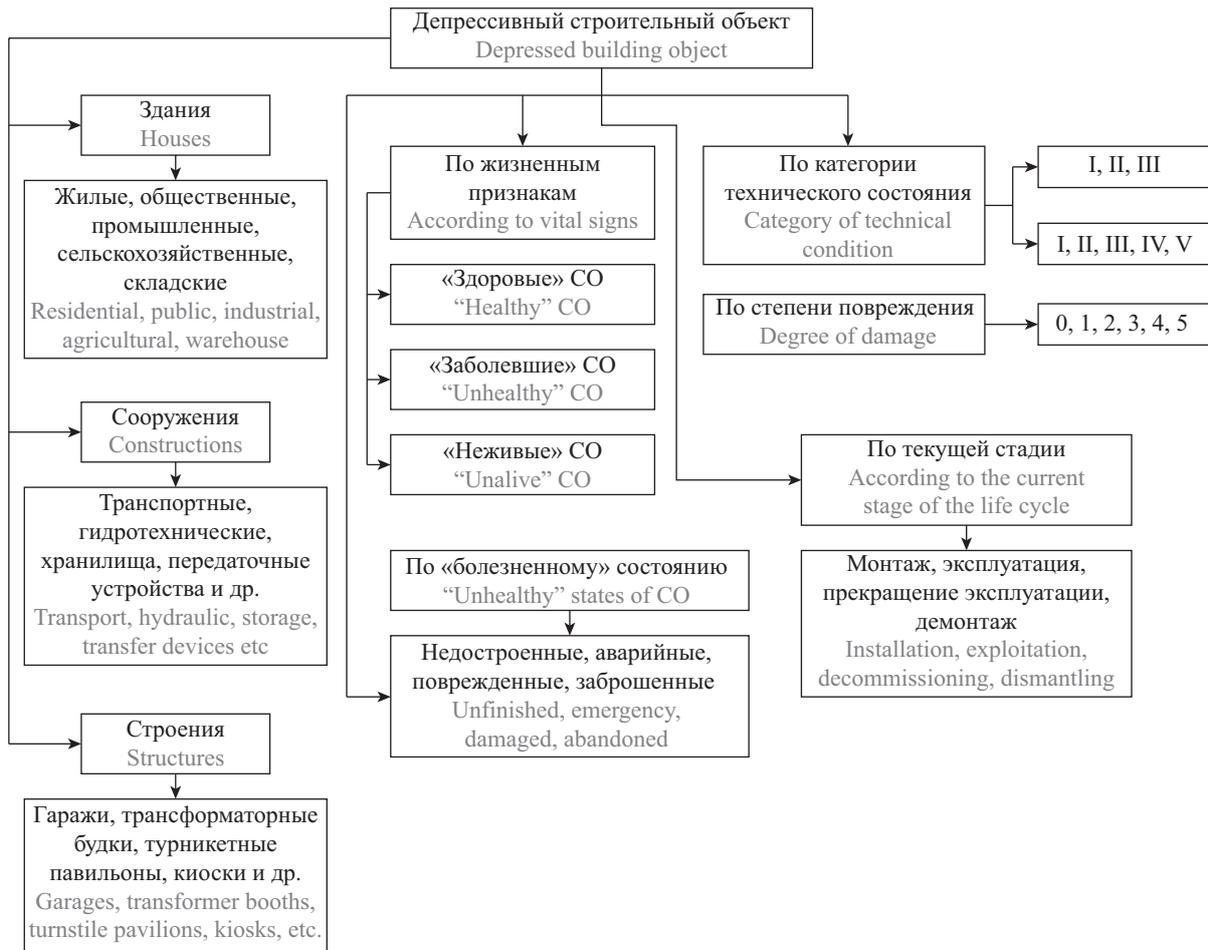
Рис. 2. Классификация ДСО с точки зрения визуального дешифрирования
