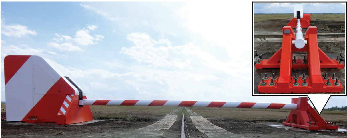
Рис. 5. Общий вид противотаранного шлагбаума до испытания
