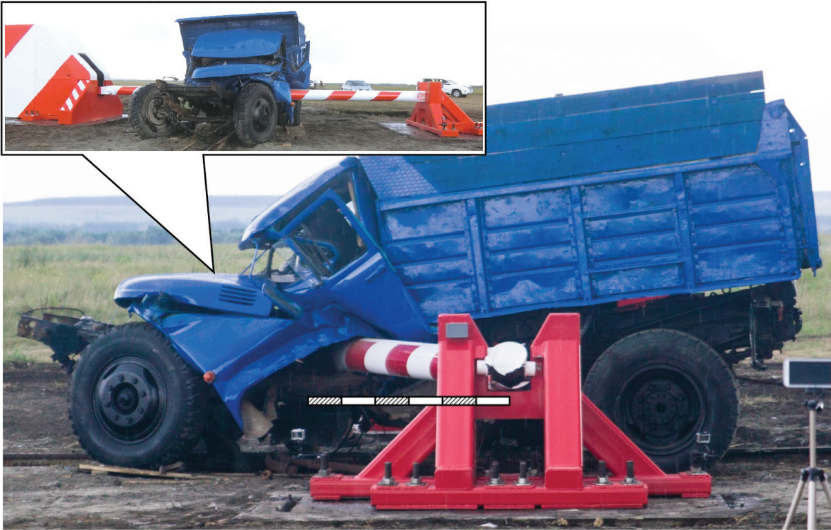
Рис. 7. Общий вид противотаранного шлагбаума и автомобиля ЗиЛ-130 после испытания Fig. 7. General view of the anti-ram barrier and the ZiL-130 car after the test
