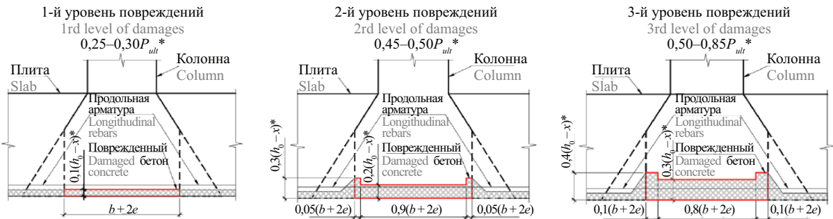
Рис. 8. Моделирование локальных повреждений, вызванных продавливанием
