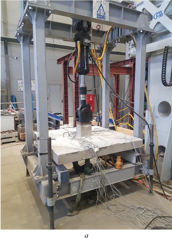
Рис. 1. Испытания узла сопряжения колонны и плиты с центральным приложением продавливающей силы: а — образец, установленный в испытательную машину; б — опалубочный чертеж и армирование испытываемого образца Fig. 1. Tests of column-slab joint with central application of pushing force: а — specimen placed in the testing machine; б — formwork drawing and reinforcement of the test specimen
