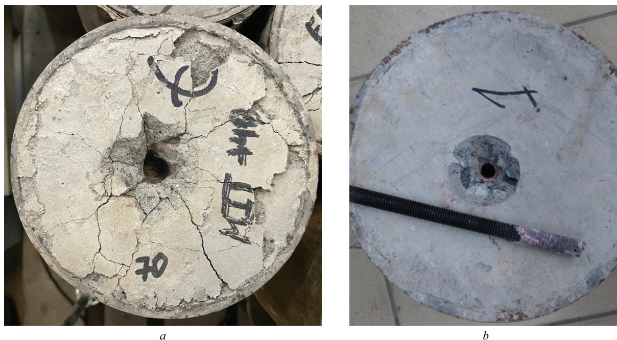
Рис. 1. Образец для испытаний отвержденного химического анкера после испытания диаметром: a — 150 мм; b — 200 мм
