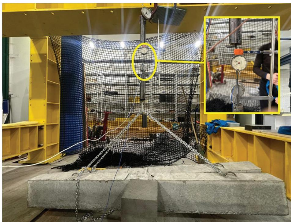
Рис. 3. Фиксация потерь напряжений в стеклопластиковой арматуре при подвешивании
