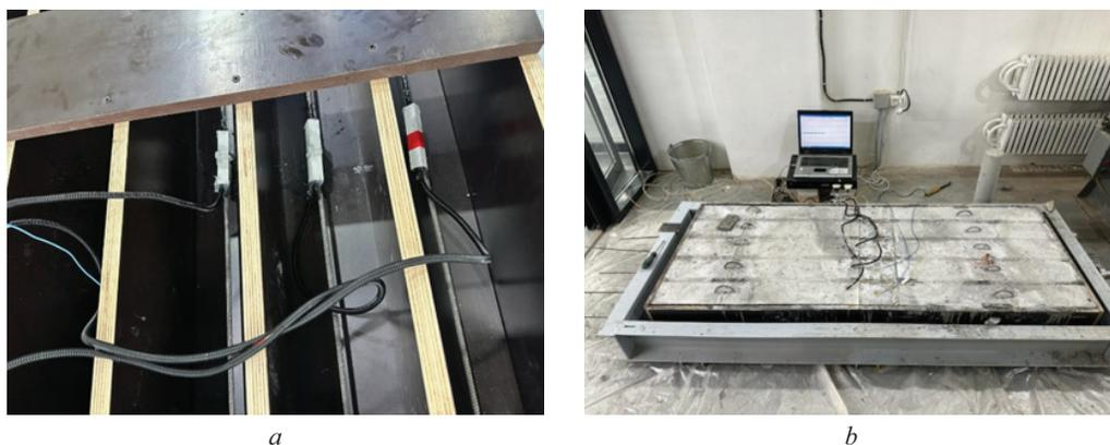
**Рис. 7.** Тензодатчики на стержнях в защитной оболочке (*a*); фиксация напряжений в арматуре во время набора прочности бетона (*b*)
