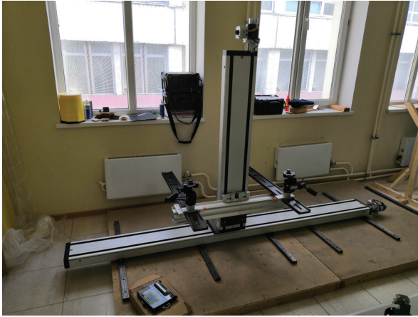
Рис. 6. Механическая система перемещения Fig. 6. Mechanical movement system
