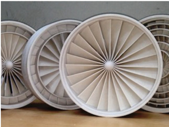
Рис. 7. Локальный лопаточный монозавихритель осевого типа Fig. 7. Local mono-vortex axial type vane swirler
