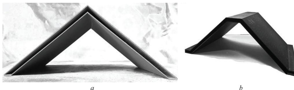
Рис. 2. Опалубочные формы: *a* — треугольная складка; *b* — трапецидальная складка
