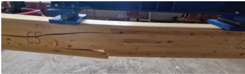
Рис. 12. Типичное разрушение образца при испытаниях на статический изгиб при коэффициенте асимметрии R = 0,2
