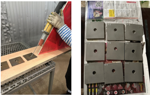
Рис. 2. Шаблон для обеспечения угла распыления и расстояния до поверхности элемента Fig. 2. A template to ensure the angle of inclination and distance to the surface of the element
