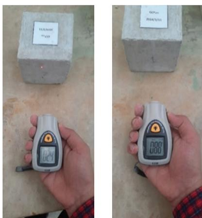
Рис. 8. Измерение разности температур для первой группы смесей (GCP 30 %)
