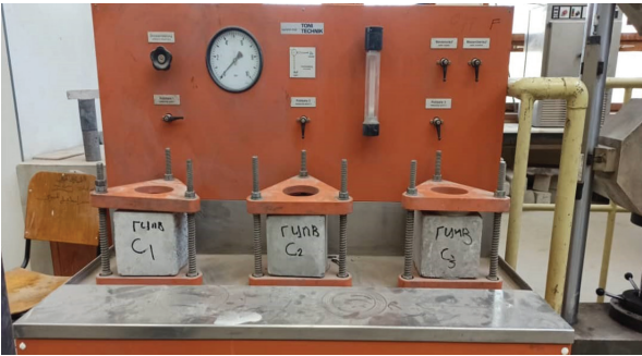
Рис. 1. Установка для испытания образцов бетона по глубине проникновения воды под давлением Fig. 1. Installation for testing concrete specimens for the depth of water penetration under pressure
