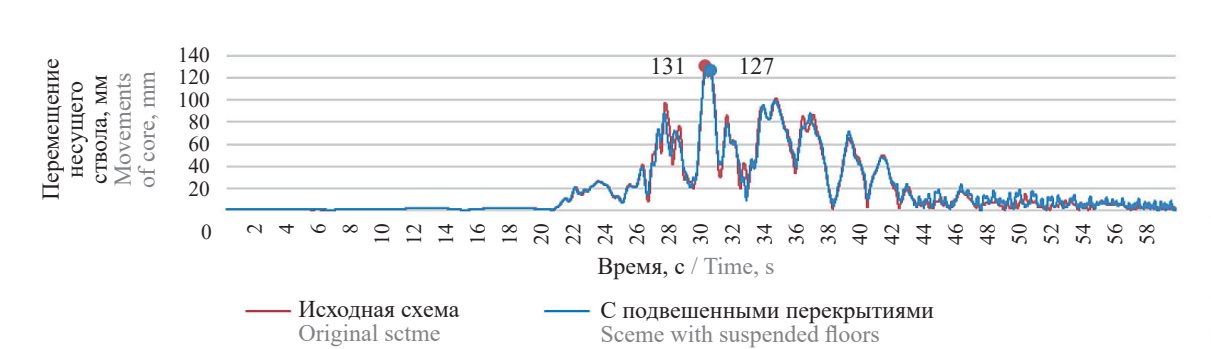
Рис. 12. Перемещения стволос расчетных моделей при M = 12,8\% с жесткими связями и при M = 19,6\% с упругими связями R = 25 тс/м
