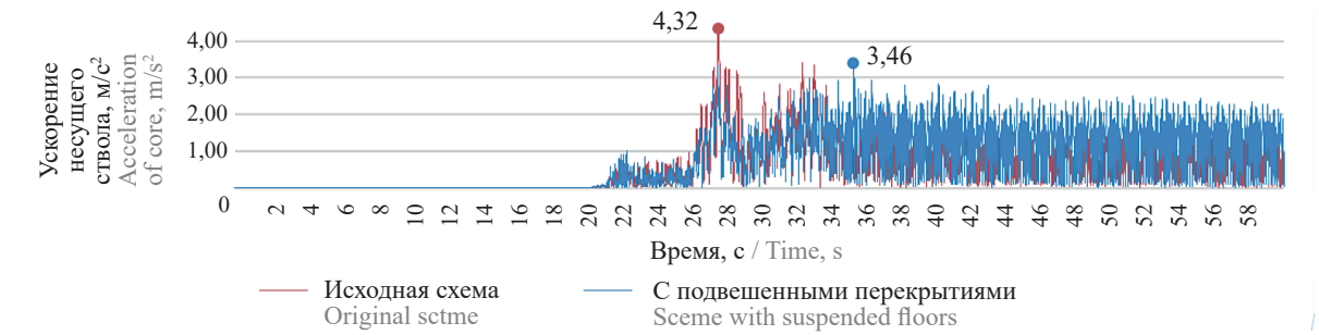
Рис. 14. Ускорения стволов расчетных моделей при M = 12,8\% с жесткими связями и при M = 30,5\% с упругими связями R = 100 тс/м Fig. 14. Accelerations of the cores of the calculation models at M = 12.8\% with rigid connections and at M = 30.5\% with elastic connections R = 100 t/m
