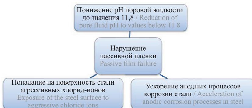
Рис. 2. Причины нарушения пассивной пленки, обеспечивающей защиту металла
