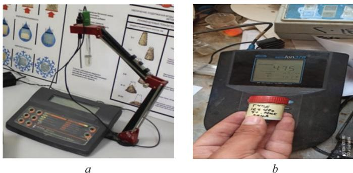
Рис. 3. Оборудование для измерения ГЦПВ суспензий: *a* — на рН-показатель; *b* — на электропроводимость
