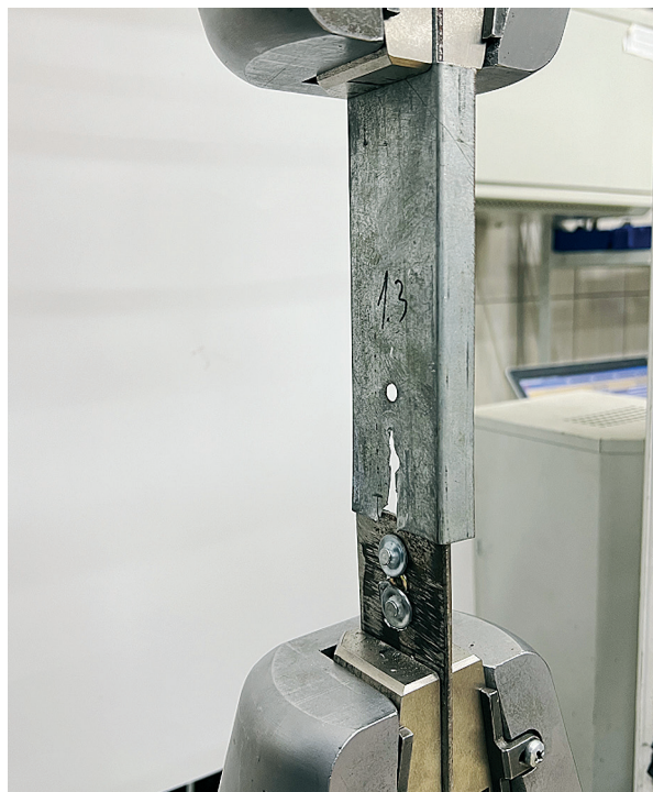
Рис. 5. Характерные повреждения оцинкованного листа в образцах 1-го типа
