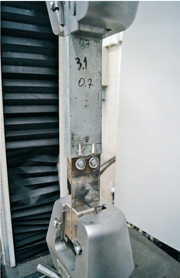
Рис. 9. Характерные повреждения оцинкованного листа в образцах 3-го типа
