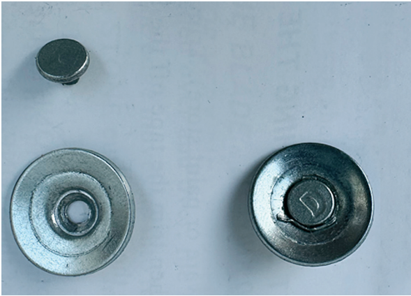
Рис. 12. Оторванные головки дюбелей после их установки в отверстия диаметром 3 мм
