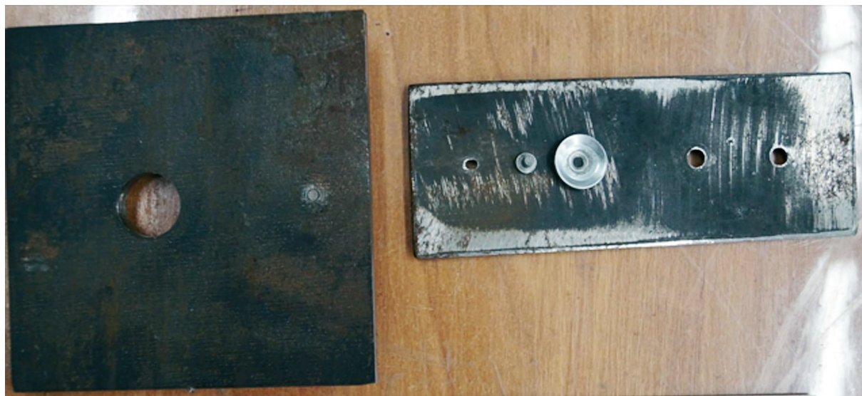
Рис. 14. Вид стальных пластин и дюбеля после разрушения однодюбельного соединения
