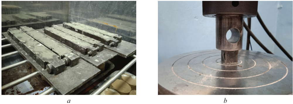
Рис. 1. Подготовка проб в формах-кубах: a — образцы в формах; b — испытания образцов Fig. 1. Preparation of specimens in cubic molds: a — specimens in molds; b — testing of specimens
