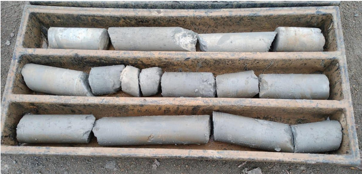
Рис. 2. Отобранные образцы грунтоцемента
