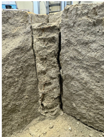
Рис. 12. Фрагмент образца после испытания. Разрушение области контакта «свая – массив»
