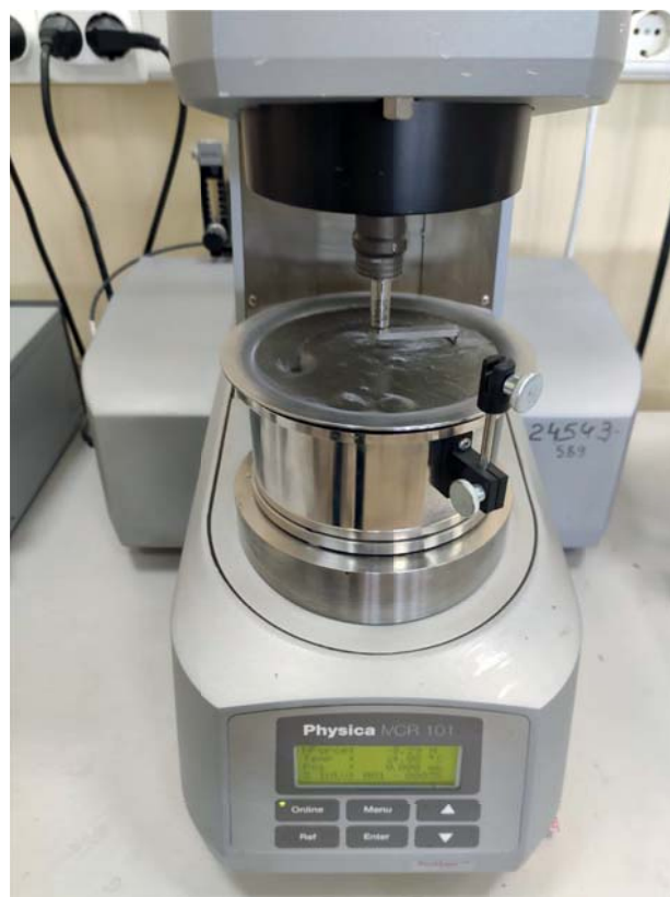
Рис. 2. Определение вязкости и напряжения сдвига бетонной смеси на полых микросферах с помощью ротационного вискозиметра MCR 101: a — схема измерения; b — внешний вид
