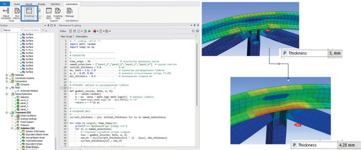
Рис. 6. Реализация вероятностной модели деградации металла ферменных элементов в ANSYS Mechanical Fig. 6. Implementation of the probabilistic degradation model for truss members in ANSYS Mechanical
