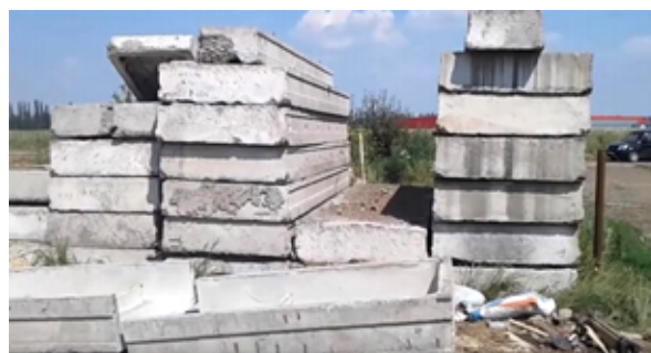
Рис. 8. Сортированные железобетонные б/у плиты перекрытия
