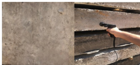
Рис. 9. Испытания бывших в употреблении железобетонных плит на прочность неразрушающим методом
