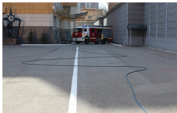
Рис. 7. Исследование местных сопротивлений (поворот на 90 и 180°)
