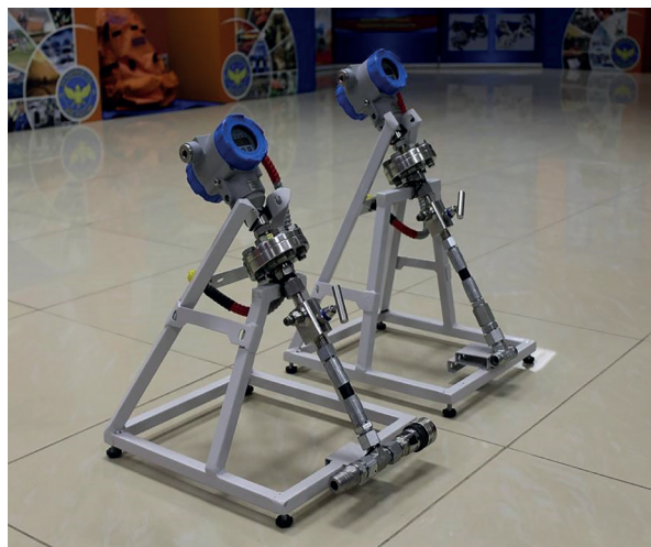
Рис. 1. Рукавные вставки с разделителями сред, клапанными блоками и датчиками давления
