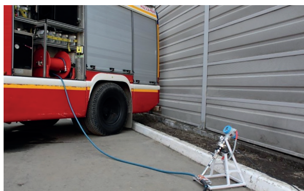
Рис. 3. Измерение избыточного давления в начале и в конце трубопровода
