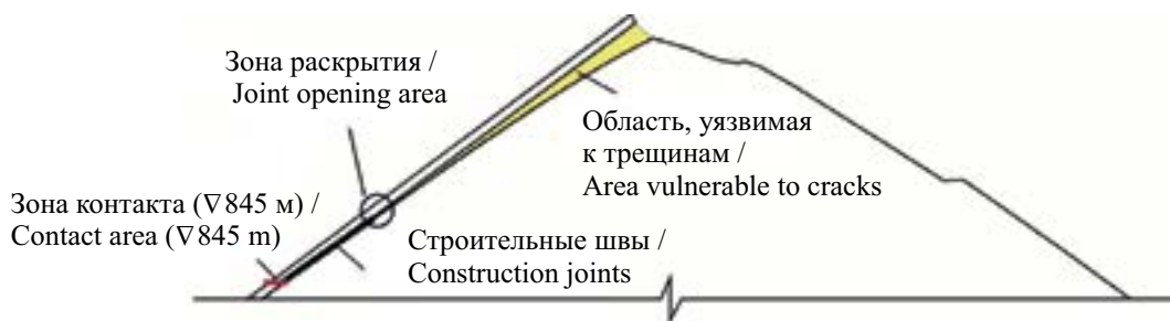
Рис. 3. Механизм разрушения при сдвиге горизонтальных строительных швов: строительные швы на отм. 845 м; зона контакта; область, уязвимая к трещинам; зона раскрытия
