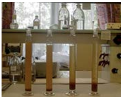
Рис. 2. Исследование кинетики осветления промывных вод станций обезжелезивания в лабораторных условиях
