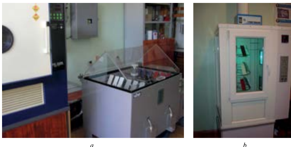
Рис. 1. Ускоренные испытания на искусственное старение защитных покрытий при воздействии: a — соляного тумана; b — двуокиси серы
