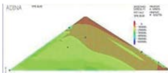
Рис. 11. Горизонтальные перемещения, м Fig. 11. Horizontal displacements, m
