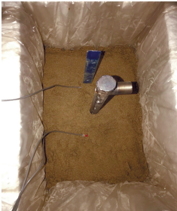
Рис. 5. Бак с установленной свайей и первой термопарой Fig. 5. Tank with a pile and the first thermal couple
