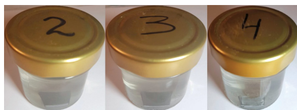
Рис. 4. Фотографии образцов при выдерживании в модели поровой жидкости бетона
