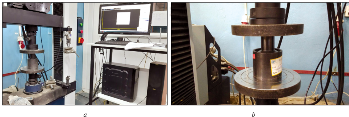
Рис. 3. Процесс проведения испытаний: a — испытательный пресс ИР 5081-5 с компьютерным управлением; b — образец в цилиндре диаметром 75 мм
