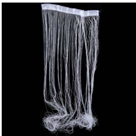
Рис. 2. Волокнистый носитель, размещенный в емкости биореактора
