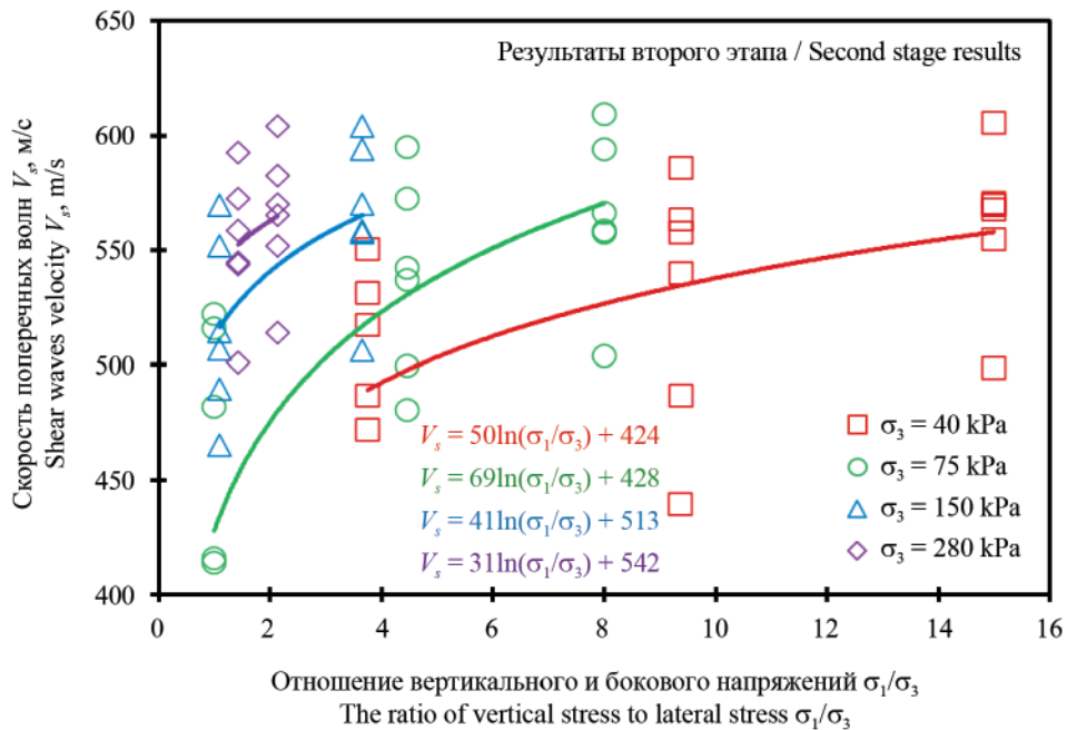
Рис. 8. Результаты второго этапа испытаний. Выполнены при различных значениях бокового давления \sigma_3 , сгруппированы в зависимости от значения \sigma_3 . Зависимость скорости распространения поперечных волн V_s от отношения вертикального напряжения к боковому \sigma_1/\sigma_3
