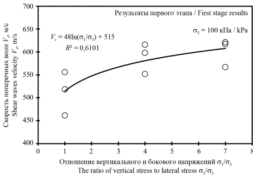
Рис. 6. Результаты первого этапа испытаний. Боковое давление \sigma_3 постоянно и составляет 100 кПа. Зависимость скорости распространения поперечных волн V_s от отношения вертикального напряжения к боковому \sigma_1/\sigma_3
