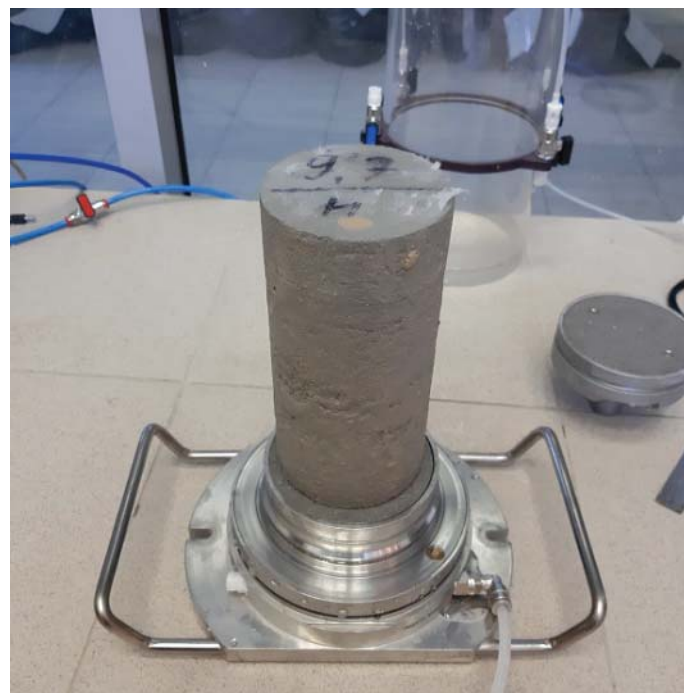
Рис. 5. Полностью водонасыщенный образец грунтоцемента на съемном нижнем пьедестале резонансной колонки
