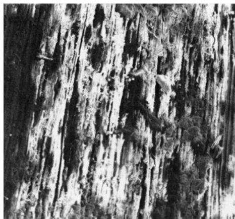
Рис. 5. Поверхность образца, модифицированного системой УНТ 1 % + НТФ 30 %
