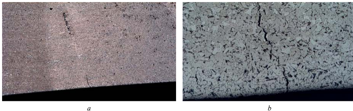
Рис. 12. Образец 14, зона сварного шва: a — увеличение 50х; b — увеличение 500х
