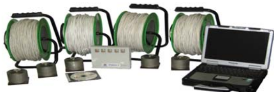
Рис. 2. Мобильный диагностический комплекс «Метод стоячих волн» (МСВ)
