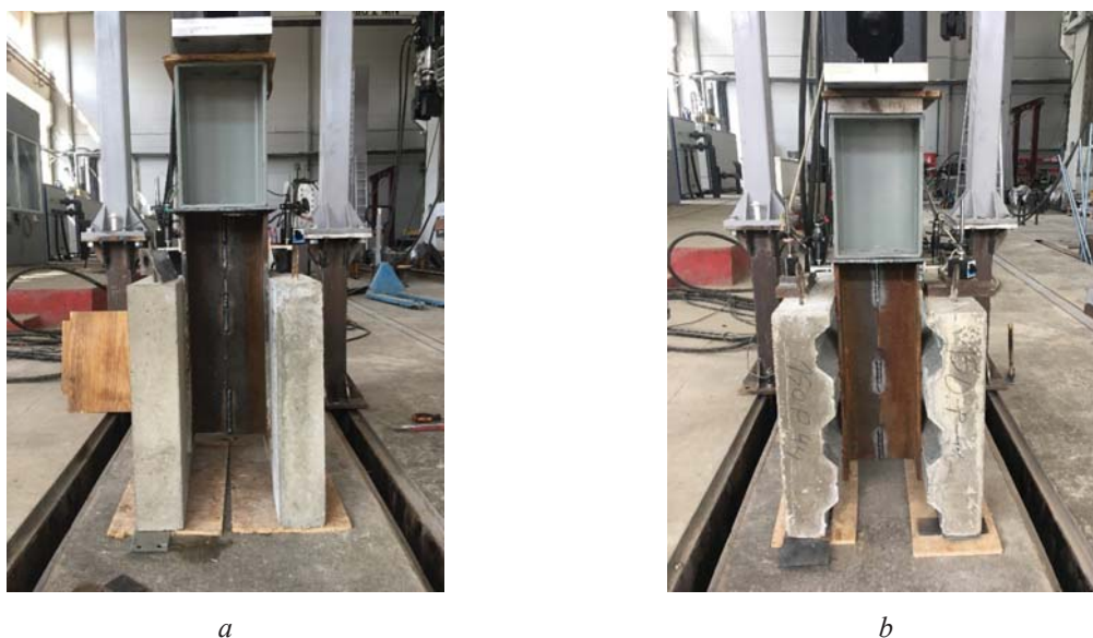
Рис. 6. Общий вид опытных образцов: а — образец первой серии; б — образец второй серии с профилированным настилом NS44
