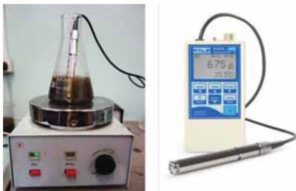
Рис. 4. Определение концентрации растворенного кислорода
