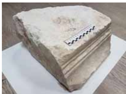
Рис. 7. Москва. Усадьба Мусиных-Пушкиных. Фрагмент белокаменного карниза, обнаруженного при архитектурно-археологических исследованиях на месте ограды, расположенной по Спартаковской улице. Фото Т.В. Иванцыка. 2019 г.
