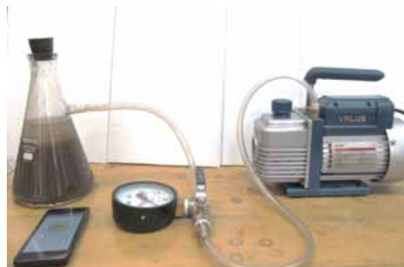
Рис. 3. Лабораторная установка дегазации (вакуумирования) иловой смеси
