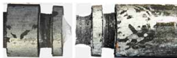
Рис. 9. Вид излома образца типа gr и деформированных зон, примыкающих к излому
