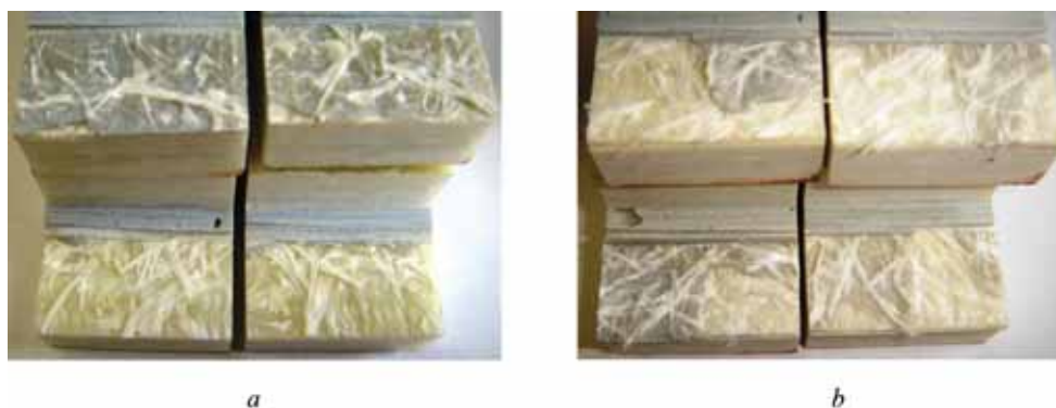
Рис. 6. Вид разрушения образцов: a — в исходном состоянии; b — после пяти циклов старения
