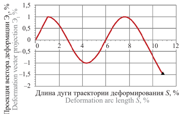
Рис. 6. Локальная диаграмма деформирования \mathcal{E}_1 - S Fig. 6. Local deformation diagrams \mathcal{E}_1 - S
