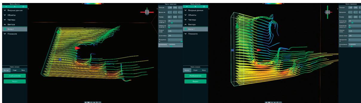
Рис. 7. Иллюстрация работы модуля визуализации линиями тока
