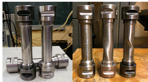
Рис. 5. Образцы оболочек из стали 45 до испытаний (слева) и после испытаний (справа)
