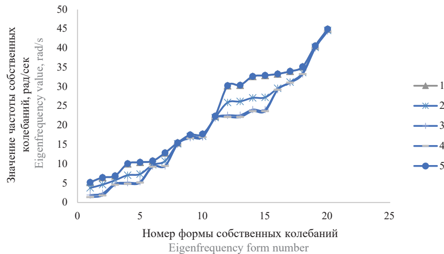
Рис. 8. Частоты форм собственных колебаний: кривые 1 получены при C = 60\,000 кН/м, K = 400 кН · с/м; кривые 2 соответствуют C = 20\,000 кН/м, K = 800 кН · с/м; кривые 3 — C = 4000 кН/м, K = 4000 кН · с/м; кривые 4 — C = 2000 кН/м, K = 8000 кН · с/м; кривые 5 — C = 1000 кН/м, K = 20\,000 кН · с/м
