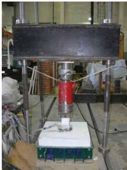
Рис. 1. Установка для испытания плит на продавливание
