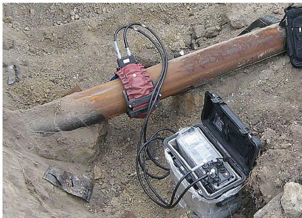
Рис. 1. Ультразвуковая система «Wavemaker» (Великобритания) для диагностики дюкеров [30]
