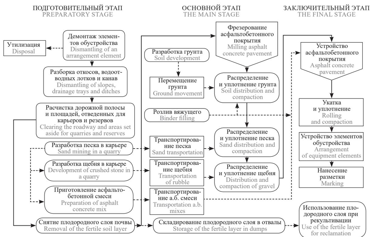
Рис. 2. Блок-схема поэтапных работ при реконструкции автомобильной дороги
