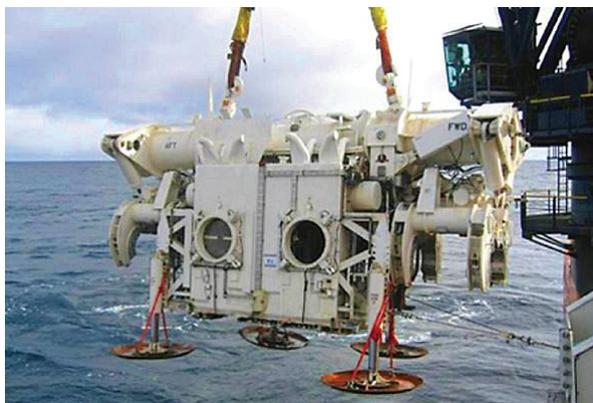
Рис. 16. Камера UWHC-1 компании Veolia Environmental Services (Франция) для ремонта подводных переходов трубопроводов [12]
