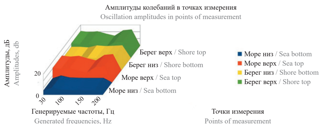
Рис. 4. Амплитудно-частотные характеристики физической модели острова с оградительными сооружениями
