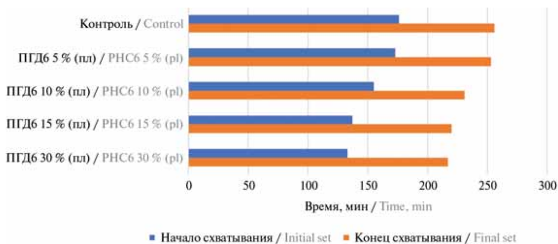
Рис. 3. Сроки схватывания составов с применением комплексной добавки
