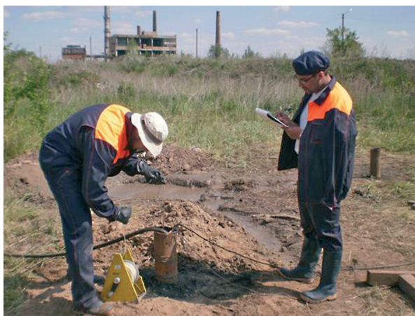
Рис. 5. Измерение начального статического уровня, а в последующем — понижения уровня Fig. 5. The process of measuring the initial static level and further level reduction
