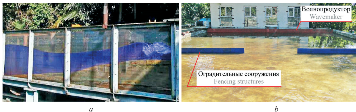
Рис. 1. Волновой лоток (а) и волновой бассейн (б) на базе АО ЦНИИТС «НИЦ «Морские берега»
