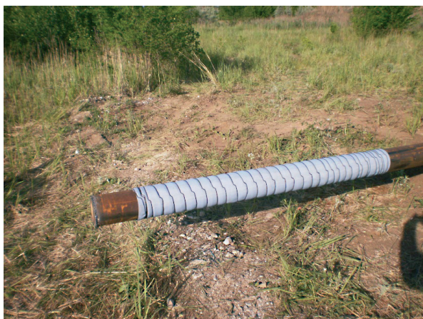
Рис. 4. Используемый сетчатый фильтр с щелевой перфорацией Fig. 4. A sieve filter having slotted perforation
