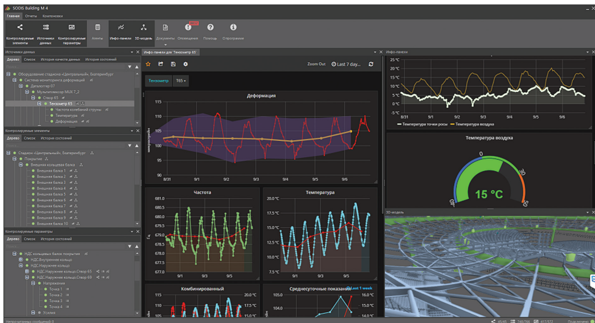
Рис. 12. Пользовательский интерфейс SODIS Building M 4.0, сконфигурированный для управления системой мониторинга «Екатеринбург Арены»
