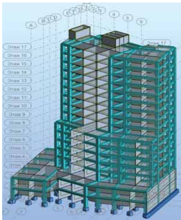
Рис. 9. Разработанная модель в виде рамно-связевой системы с диафрагмами жесткости
