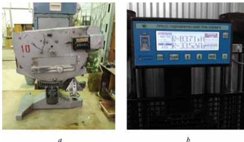
Рис. 5. Испытательные машины для определения предела прочности цементного камня при изгибе (а) и сжатии (b)
