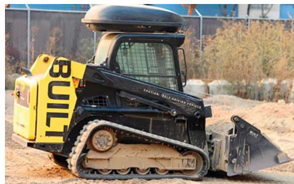
Рис. 4. Беспилотный экскаватор Built Robotics (снимок экрана видео на YouTube-канале Built Robotics)
