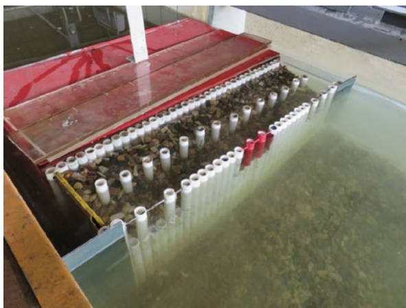
Рис. 9. Вид каменного откоса за вертикальной стенкой причала в опыте № 4
