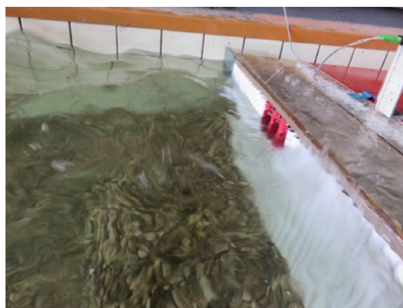
Рис. 6. Воздействие волн ЮВ направления на модель причала в опыте № 2
