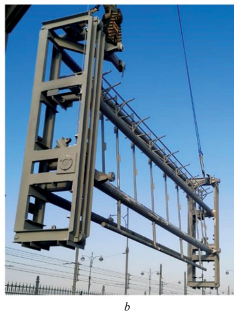
Рис. 3. Универсальная рамная конструкция для проведения энергетических испытаний: а — математическая модель; б — изготовленная конструкция для проведения испытаний
