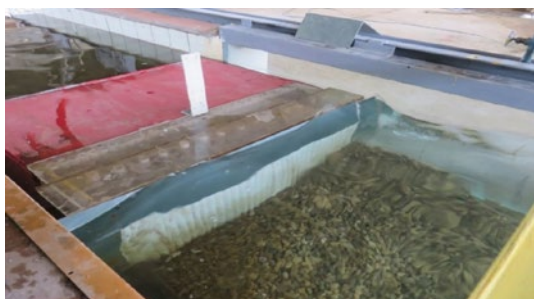
Рис. 4. Воздействие волн ЮВ направления на модель причала в опыте № 1
