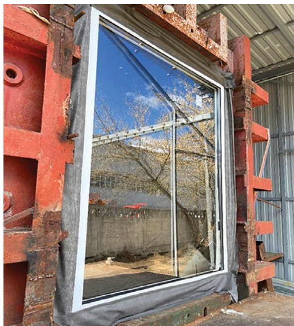
Рис. 2. ЛСК из алюминиевого профиля, перед испытанием на воздействие аварийного взрыва
