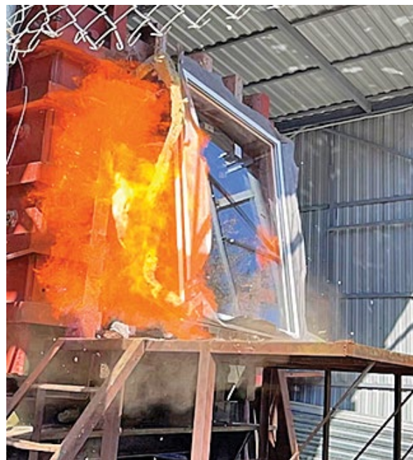
Рис. 3. Испытание ЛСК на воздействие аварийного взрыва
