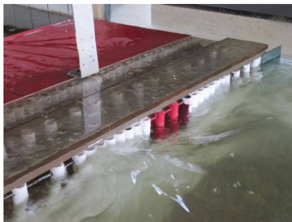
Рис. 10. Воздействие волн ЮВ направления на модель причала в опыте № 4
