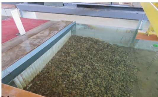
Рис. 3. Подготовленная к опыту № 1 модель причала в волновом лотке
