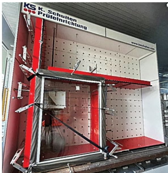
Рис. 4. Испытание ЛСК на сопротивление ветровой нагрузке
