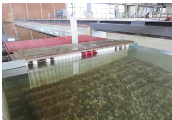
Рис. 7. Модель причала опыта № 3 в волновом лотке
