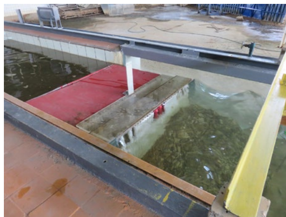
Рис. 8. Воздействие волн ЮВ направления на модель причала в опыте № 3
