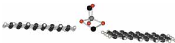
Рис. 8. Начальное расположение модельного фрагмента минерального вяжущего и двух графеновых кластеров
