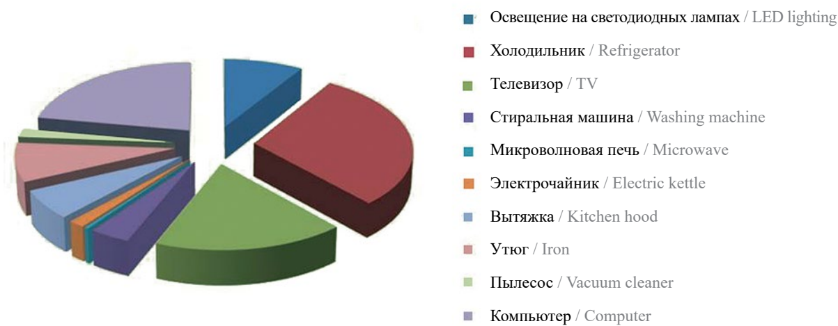
Рис. 1. Структура усредненного потребления электрической энергии в бытовых целях без затрат на отопление и подготовку горячей воды
