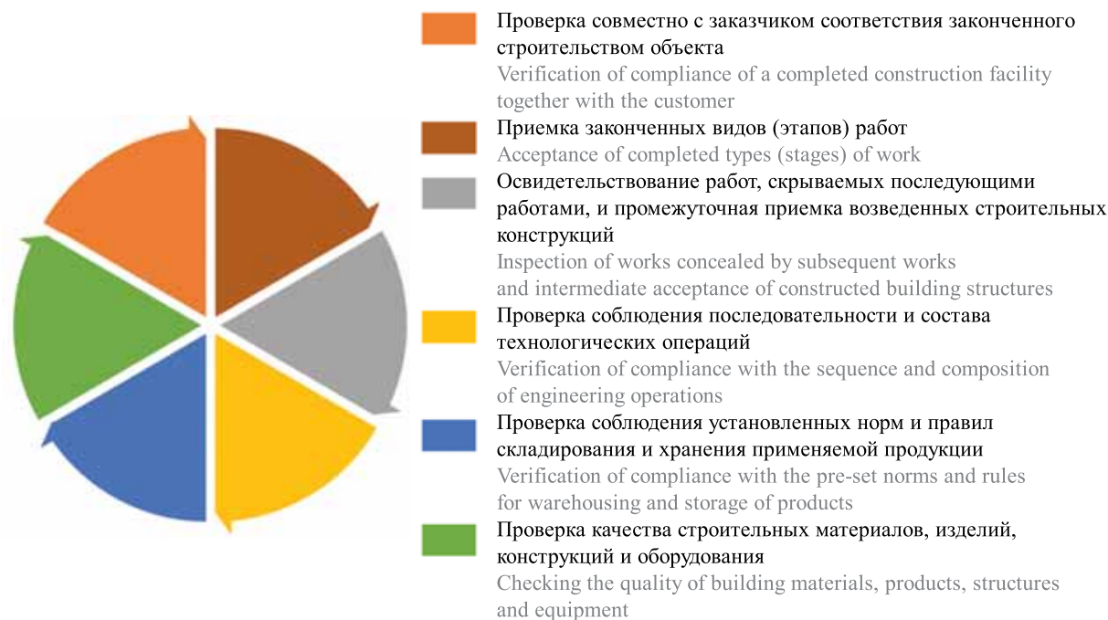
Рис. 3. Мероприятия строительного контроля, проводимые подрядчиком на этапе строительства
