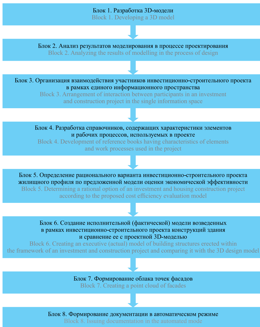
Рис. 9. Модифицированный вариант обобщенного алгоритма применения технологии BIM в практике жилищного строительства, учитывающий возможности оценки экономической эффективности вариантов ИСП жилищного профиля по предложенной модели
