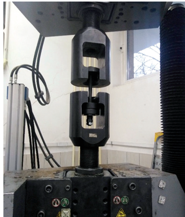
Рис. 1. Установка высокопрочного болта в разрывной машине
