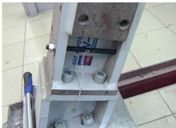
Рис. 3. Испытание болта в силовой раме
