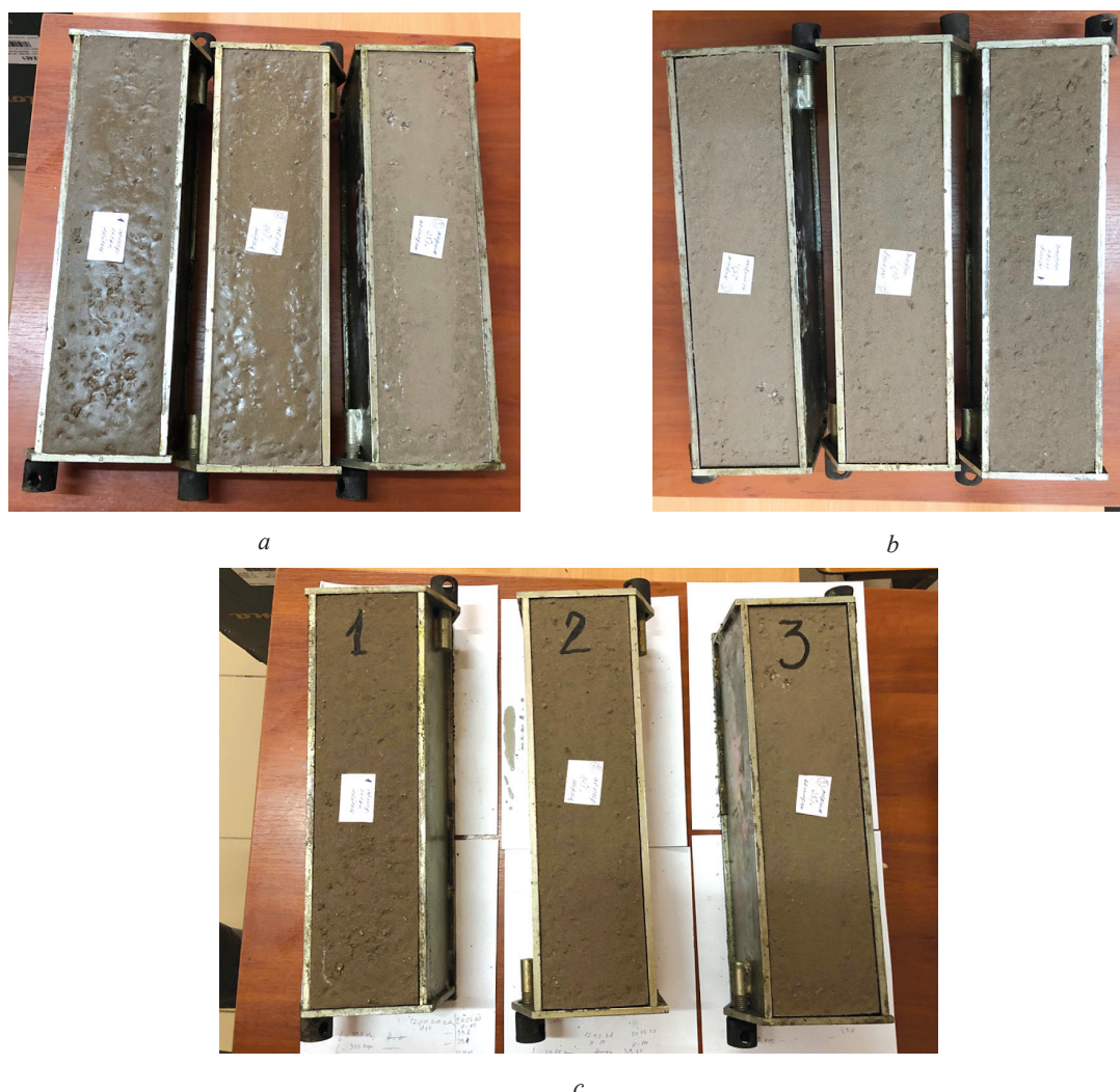
Рис. 3. Общий вид испытаний призм на усадочные деформации
