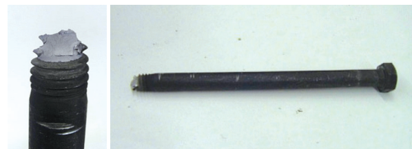
Рис. 2. Разрушение болта по нарезанной части
