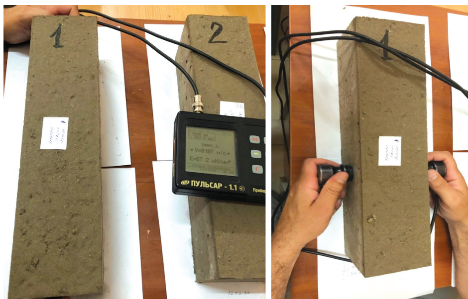
Рис. 2. Процесс проведения испытаний на приборе Пульсар-1.1
