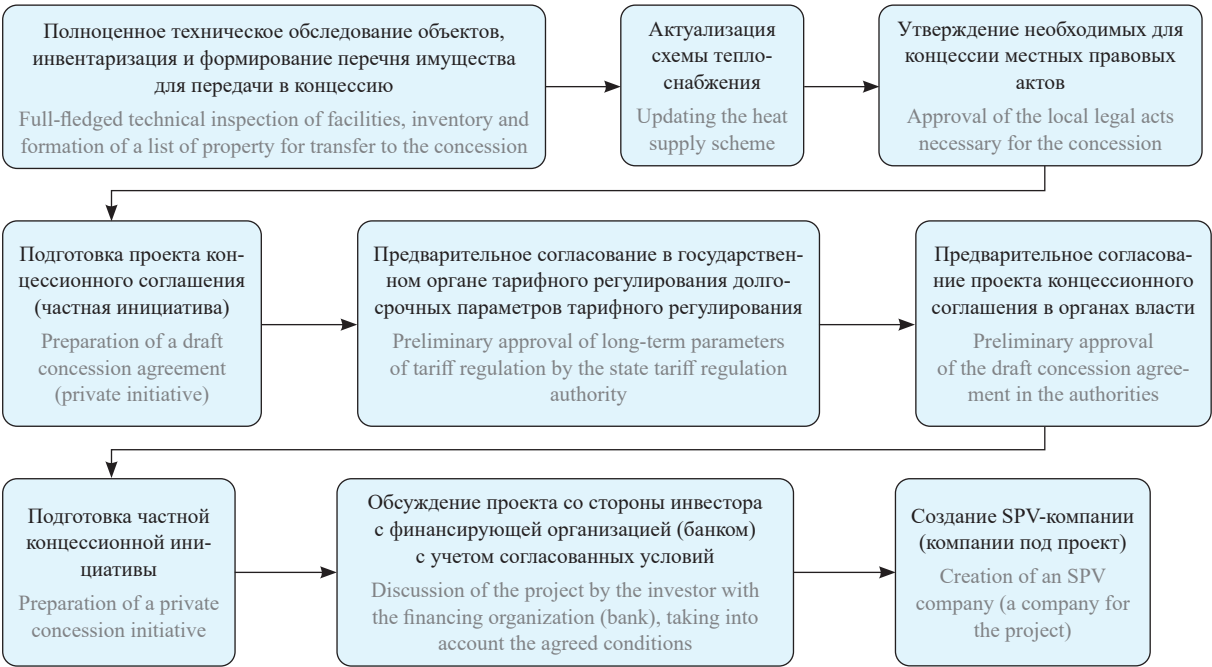
Рис. 7. Последовательность шагов подготовительного этапа проекта модернизации теплоснабжения в соответствии с концессионным соглашением (составлен автором по материалам О.В. Устинова [13])
