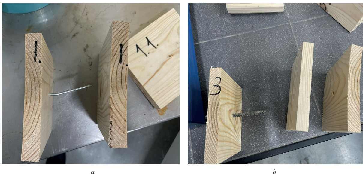
Рис. 3. Формы деформации нагелей из различных материалов: a — гвоздь; b — полимеркомпозитная арматура Fig. 3. Forms of dowel's deformation from various materials: a — a nail; b — polymer composite reinforcement
